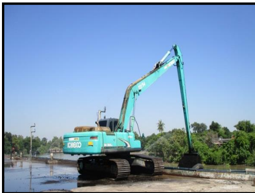
ภาพที่ 2.6 รถแบ็คโฮตักถ่านหิน สวิงให้เข้าเพื่อป้องกันการร่วงหล่นของถ่านหิน
