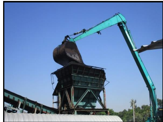
ภาพที่ 2.6 รถแบ็คโฮตักถ่านหิน สวิงให้เข้าเพื่อป้องกันการร่วงหล่นของถ่านหิน
